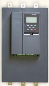
**Серия SRM-B-(5.5...315)-M** – универсальное и многофункциональное устройство плавного пуска для двигателей мощностью от 5.5 до 315кВт. Для работы в промышленных сетях устройство плавного пуска имеет встраиваемый интерфейс rs-485(Modbus RTU), и аналоговый выход (4-20mA). Имеет функцию “ПОЖАРНЫЙ РЕЖИМ”. Применение: центробежные и погружные насосы, вентиляторы, винтовые компрессоры, дробилки, конвейеры, шаровые мельницы, центрифуги, дробилки и др. оборудование.
