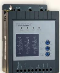
**Серия SRM-B-(0.75...75)** – универсальное и компактное устройство плавного пуска для двигателей мощностью от 0.75 до 75кВт. Имеет напряжение управления 220В АС и 24В DC. Для работы в промышленных сетях устройства плавного пуска имеет встраиваемый интерфейс rs-485(Modbus RTU). Применение: центробежные и погружные насосы, вентиляторы, винтовые компрессоры, дробилки.
