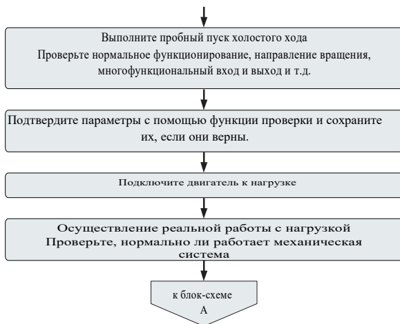
Рисунок 4-6 Этапы работы в режиме векторного управления с открытым контуром
